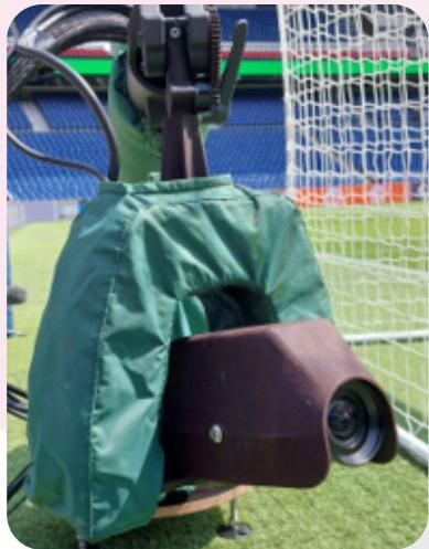
La **PELICAM'S** est une caméra spéciale, installée sur une grue robotisée. C'est l'outil idéal pour filmer à l'arrière des buts de football.
